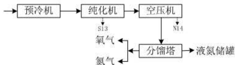
图3.4-3 制氮工艺流程及排污节点图
